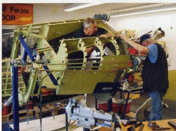
In Hamburg bauten die Ehrenamtlichen unter anderem die Leitwerksaufnahmen und die kompletten Leitwerke auf.
