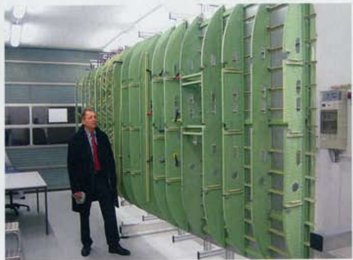
Der Rumpfboden gehört zu den größeren Segmenten der Fw 200 Condor. Auch er wurde zunächst am Computer rekonstruiert.
