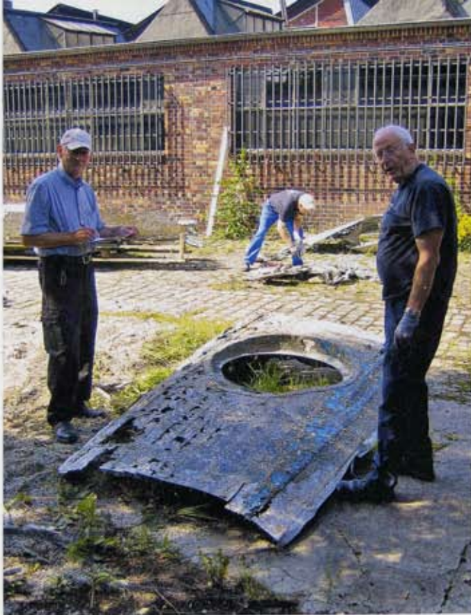
Der Rumpfboden gehört zu den größeren Segmenten der Fw 200 Condor. Auch er wurde zunächst am Computer rekonstruiert.
