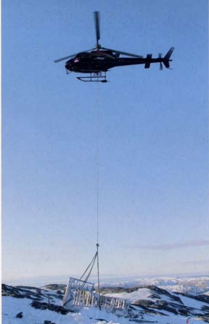
Ein nur wenige Stunden kurzes Wetterfenster nutzte die Besatzung der AS 350 Écureuil, um die Flügelsegmente aus dem Schneefeld in über 1400 m Höhe zu bergen. Der Zustand der Wrackteile lässt ihre Rekonstruktion noch sehr gut zu (oben und rechts).
