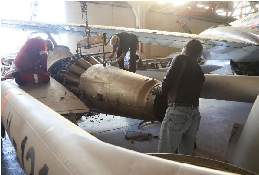
Fra fjerning av motoren
