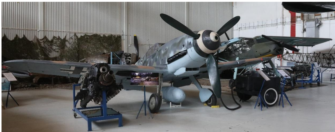
BF 109 med Db 605A på venstre side og oljevvarmer på høyre side
