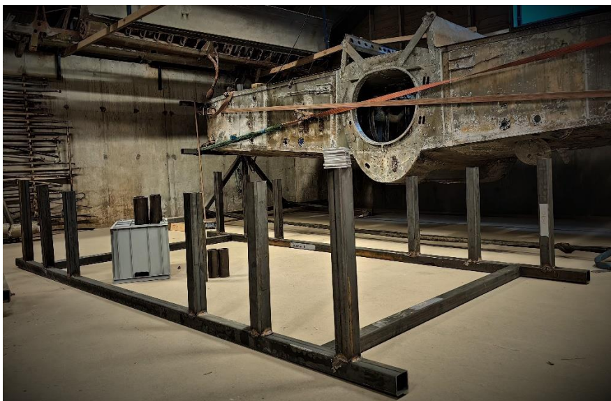
Rammen til en jigg som senterseksjonen skal settes inn i.
