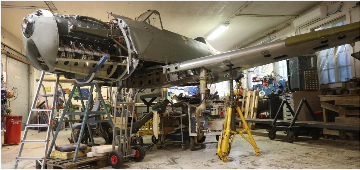
Arado 96 etter at vinger og kropp er koblet sammen.
