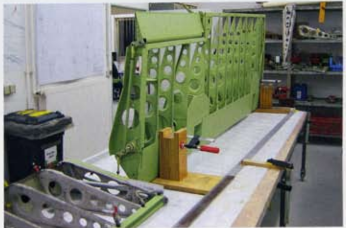
Die Querruder samt Trimmung wurden mit den am Kvitansoi geborgenen Wrackteile in Bremen bereits fertiggestellt.
