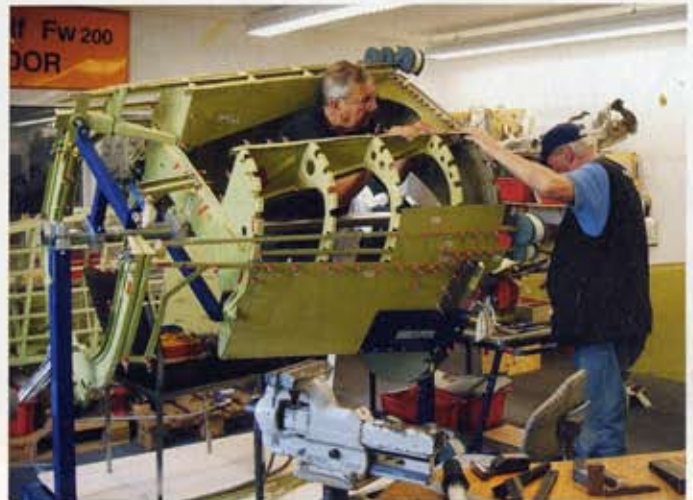
In Hamburg bauten die Ehrenamtlichen unter anderem die Leitwerksaufnahmen und die kompletten Leitwerke auf.
