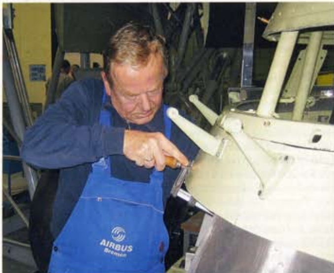
Die Motorgondeln für die Bramo-Sternmotoren wurden in Bremen restauriert. Hier werden die Kühlluftklappen angepasst.
